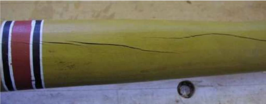
Nota : J'emploie la même technique de réparation que ce soit pour de petites fissures ou pour de plus grosses. j'utilise juste un couteau au lieu d'un burin pour élargir et approfondir les fissures.
